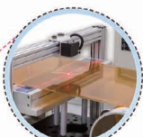
本装置(AIと機械振動を利用 した異物検知システム)
