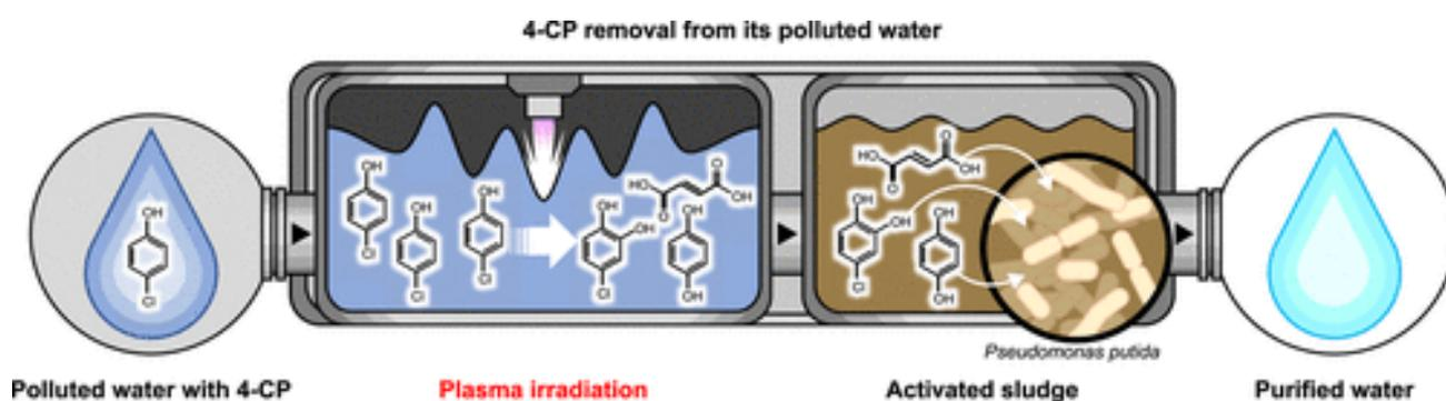
図7 4-クロロフェノール汚染水のプラズマ支援浄化装置の概念図
