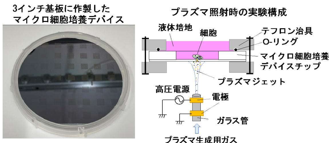
図8 マイクロ細胞培養デバイス（左）を用いた、細胞へのプラズマ照射実験（右）。
