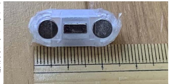
腸内フローラを回収するため磁気で駆動するロボット
