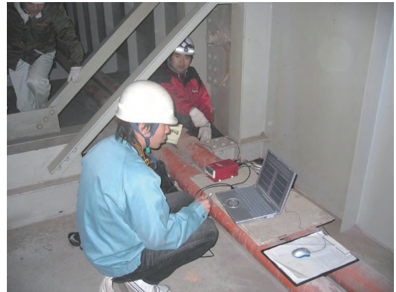
疲労き裂発生原因の原位置検証
