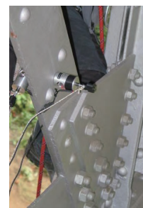
ロックライマーによるひずみ測定作業の効率化（スイスの事例）
