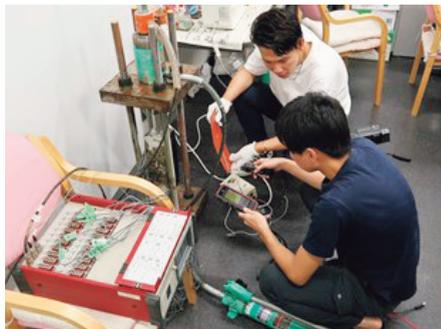
写真：赤外線サーモグラフィによるFRPシートのマクロ剥離を検知する実験を研究室の学生が行っている様子
