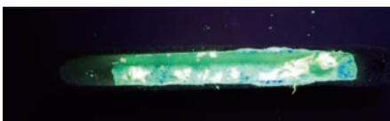
図1. 私たちの研究室で開発した蓄光材料。アルミン酸ストロンチウムに希土類を添加した無機材料を使用して開発。
