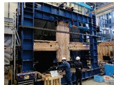
高層建物を想定したCLT木質制振架構の各種実験
