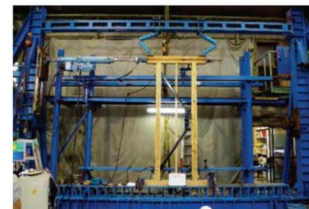
図2 開発した制振壁の認定試験の様子
